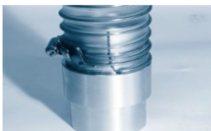
Variante 1: Wendel freilegen, nach innen biegen und auf einen leitfähigen Stutzen montieren.
