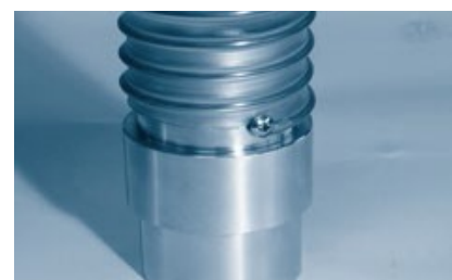
Variante 2: Wendel freilegen und z.B. mittels Niete oder Schraube befestigen.
